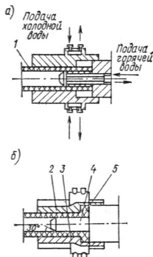
**Рис. 17. Схема формования утолщеною бурта на конце трубы**
