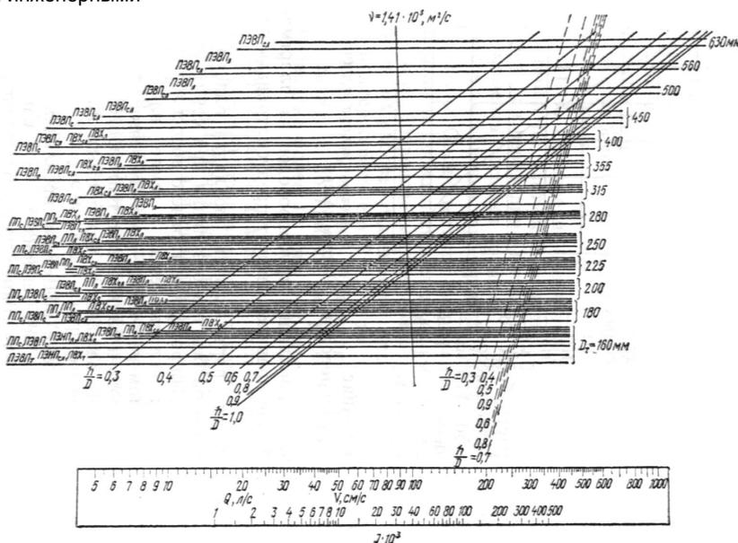
Рис. 8. Номограммы для гидравлического расчета пластмассовых канализационных труб
