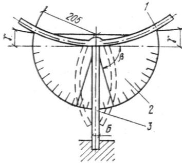
**Рис. 20. Схема испытания пластмассовых труб на статический изгиб**
