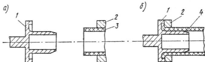
Рис. 16. Схема формования отбортовки
