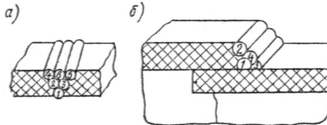
**Рис. 21. Порядок укладки сварочных прутков в шов**
