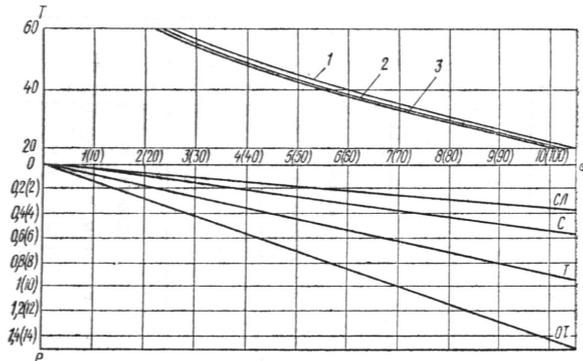
**Рис. 4. Номограмма для определения рабочего давления в трубопроводе из ПВХ-100 в зависимости от срока службы трубопровода**
