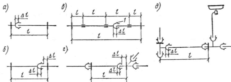
**Рис. 15. Варианты расстановки креплений на канализационном трубопроводе**
