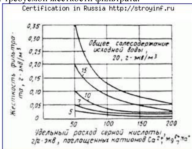
Рис. 2. График для определения общей жесткости воды, умягченной водород-катионированием
