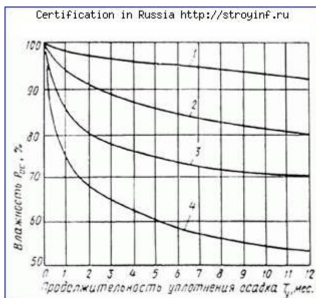
Рис. 4. Средние значения влажности осадка станций обезжелезивания и реагентного умягчения воды при уплотнении до одного года
