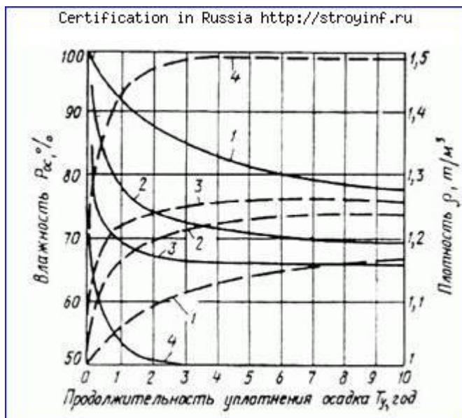
Рис. 2. Средние значения влажности и плотности осадка станций обезжелезивания или реагентного умягчения воды при многолетнем уплотнении
