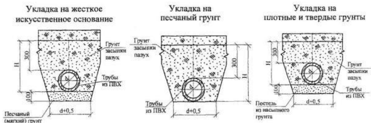
Рисунок 9 - Схемы укладки труб из ПВХ в грунте
